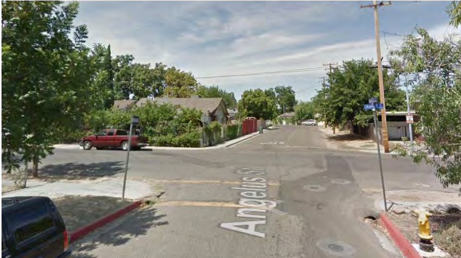
La intersección de la Calle Angelus y la Avenida Orange al sur carece señales de alto en tres de sus cuatro patas, creando frecuentes conflictos entre los conductores
